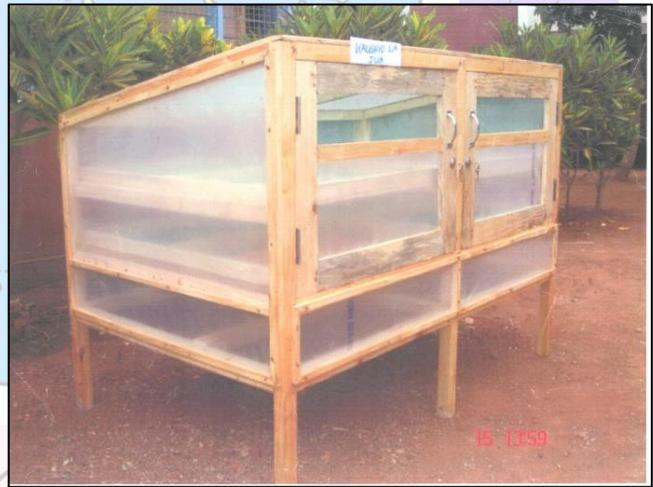
**Photo d'un séchoir solaire utilisé pour la formation et les petites entreprises de séchage de produits en Tanzanie**
