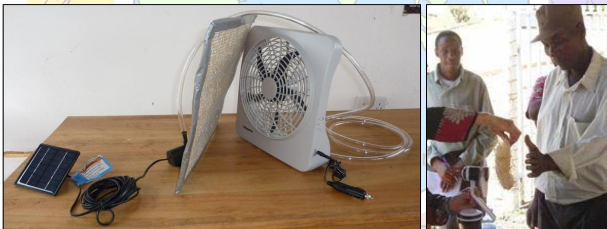
**Une démonstration de refroidissement par évaporation simple et portable**
