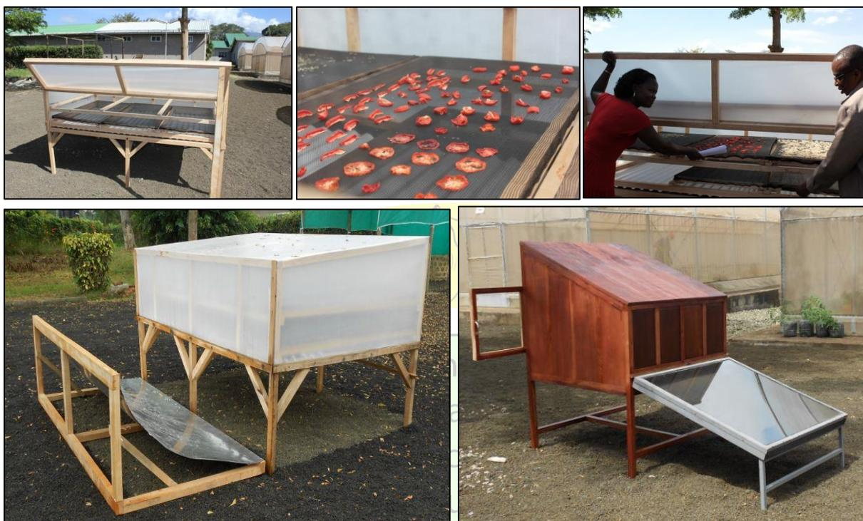
**Réflecteur ajouté à un simple séchoir direct, et séchoir à armoire indirecte amélioré avec capteur solaire (nécessite quand même l'ajout d'une cheminée)**
